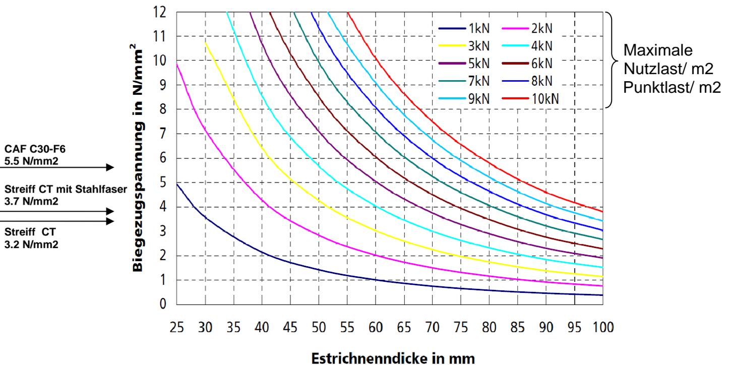
Bei Zementestrichen mit im Estrichmörtel egebetteten Heizrohren ist die Dicke um den Rohraussendurchmesser zu erhöhen!
